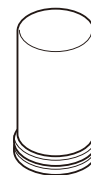
③ Filtru de apa de rezerva cu carbon active de tip HG-N
