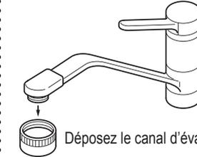
Un canal d'évacuation d'aérateur (type à vis extérieure) est nécessaire. Il existe deux types de canaux d'évacuation en mousse (M22 noir). Choisissez l'un ou l'autre.
