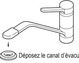
Un canal d'évacuation d'aérateur (type à vis intérieure) est nécessaire. Il existe deux types de canaux d'évacuation en mousse (M24 gris). Choisissez l'un ou l'autre.
