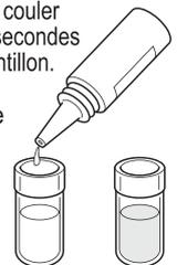
3. Comparer la couleur de l'eau dans l'éprouvette au tableau de couleurs et vérifier la concentration du pH.
