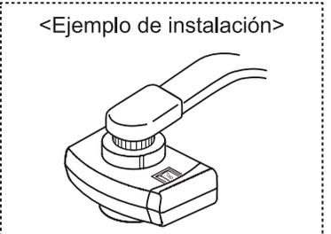
**!** Si el diámetro de la rosca o el paso de la rosca no encaja, la rosca podría resultar dañada. Asegúrese de que el diámetro y el paso de la rosca sean los especificados.
