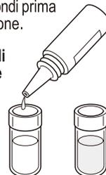
**3. Confrontate il colore dell'acqua nella provetta di test con quello della tabella comparativa colore, ottenendo la concentrazione di pH.**
